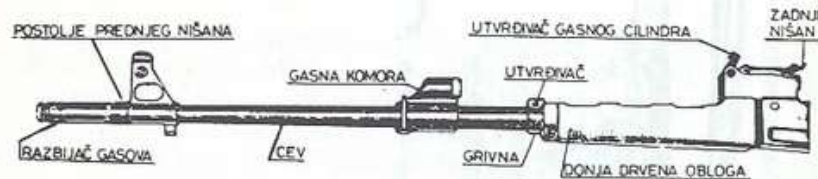
Sl. 3 – Delovi cevi sa razbijačem gasova
